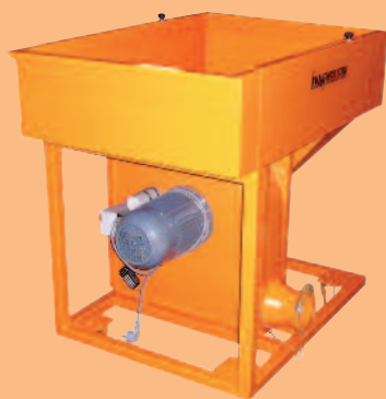
Machine à souffler monobloc pour laine de verre en vrac, bac, ventilateur (2cv), 20 m de tuyau.
