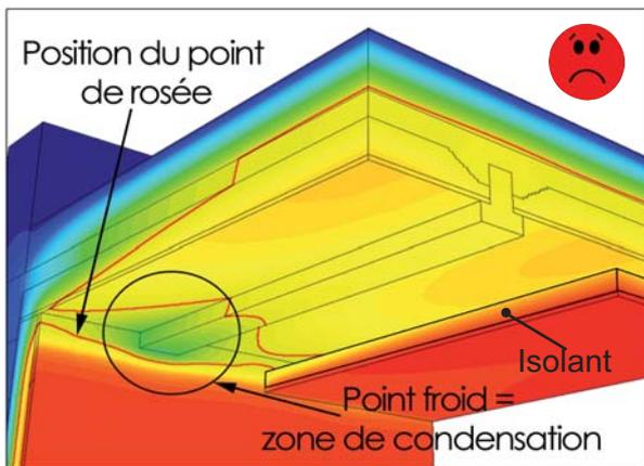
Point froid dans le Plénum dû à la présence de l'isolant sous les poutrelles.
