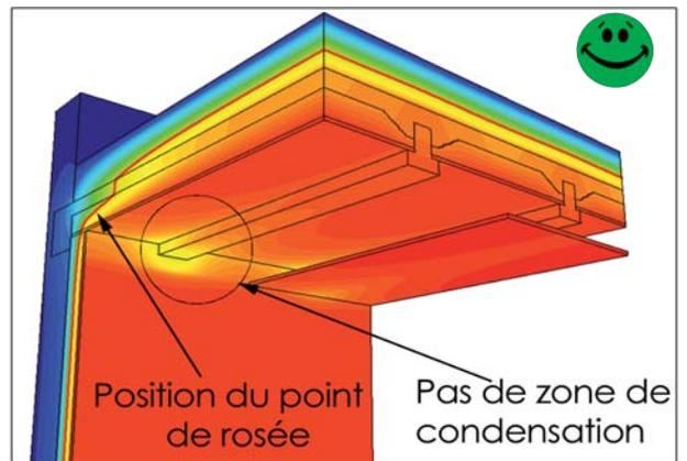
Pas de point froid car le Seacbois traite le pont thermique. Les poutrelles sont dans la zone chauffée.
